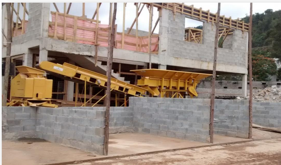
Figura 5 - Máquina Queixada, utilizada para reciclagem
